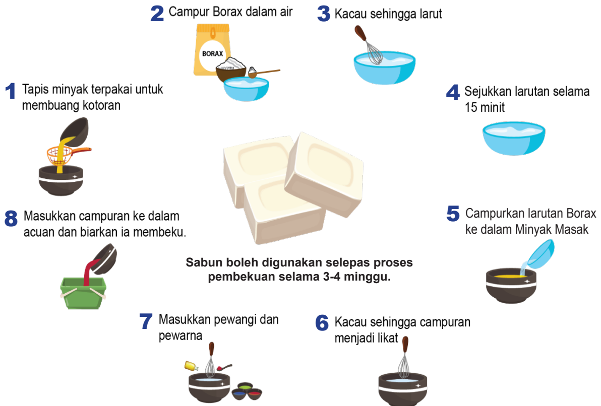
Rajah 11 : Langkah-Langkah Pembuatan Sabun Dari Minyak Masak Terpakai
